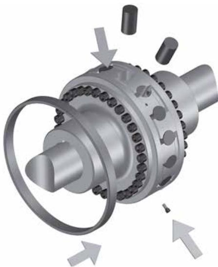
Das Mittelteil ist radial aushebbar bzw. einseitig lösbar. Dadurch kann die Montage von schweren Antriebskomponenten erleichtert werden. Ebenso ist eine Drehrichtungsprüfung des Elektromotors möglich.
