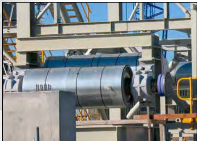
Bandtrommel mit Spannsätzen und einer Schrumpfscheibe auf der Antriebsseite Conveyor pulley with Locking Assemblies and a Shrink Disc on the drive side
