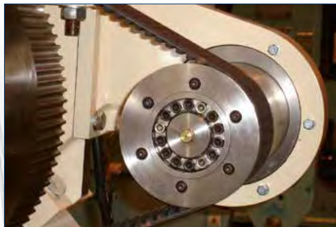
Spannsatz / Locking Assembly RfN 7012 · Zahnriemenscheibe / Belt pulley
